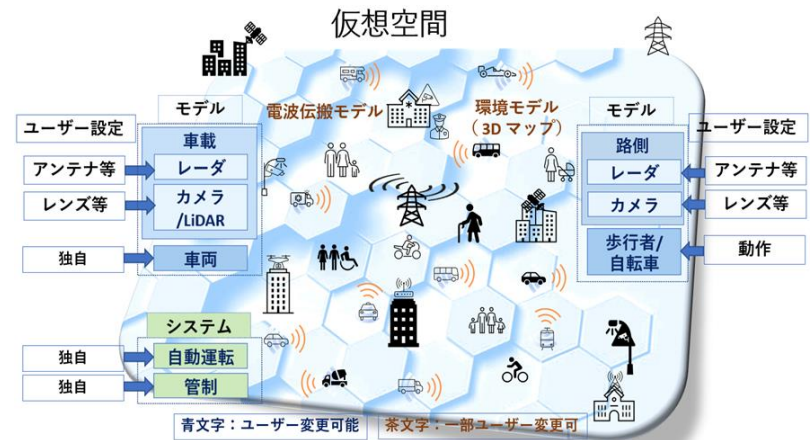
図2.ITSエミュレータの概念図
